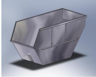
Absetzcontainer 7 m<sup>3</sup> mit Klappe
